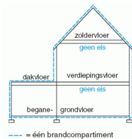
Afbeelding 3 Vloeren in verschillende woonlagen
